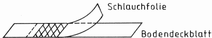
Bild 2: Probekörper in Querrichtung, in einer Breite von 15 mm aus dem Boden (Bild 1) ausgeschnitten. Bodenblatt und Schlauchfolienenden dienen zum Einspannen.
