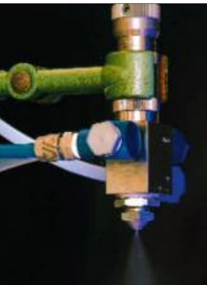
Mit dieser Zweistoffdüse wurden die Spo- rensuspensionen auf das Trägermaterial gesprüht und dann UV-bestrahlt
